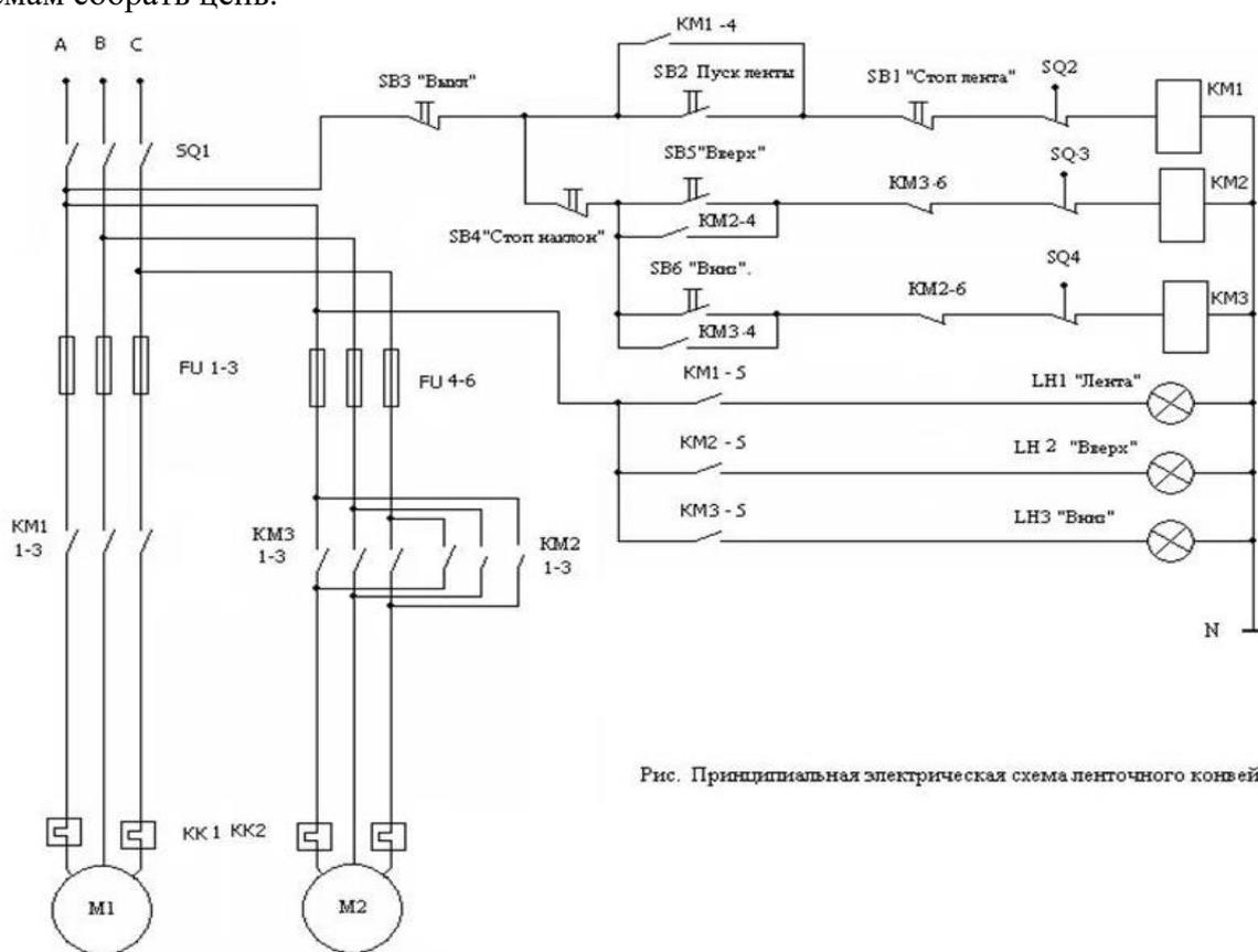
Рис. Принципиальная электрическая схема ленточного конвейера
